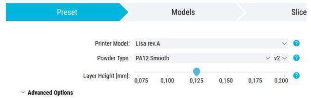
Abb. 2.5: Auswahl der Pulverversion.
